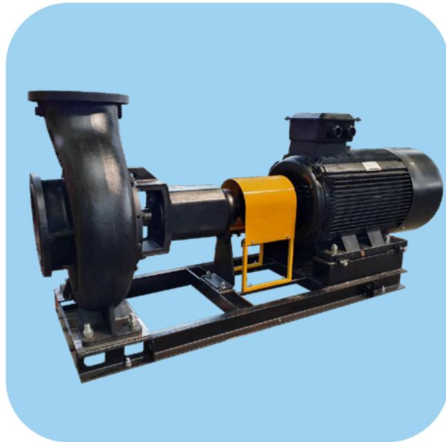
Несамовсасывающие консольные/консольно-моноблочные центробежные одноступенчатые насосы с горизонтальным расположением вала ротора, осевым всасывающим и радиальным напорным патрубками.
