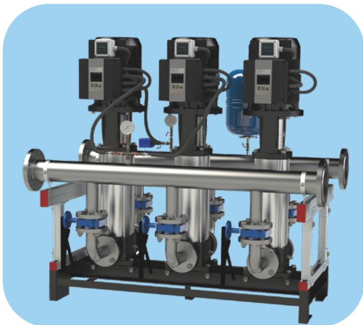
Насосные установки повышения давления — это малогабаритные установки, собранные на базе вертикальных многоступенчатых насосов серии CDL (в количестве от 2-х до 4-х шт.), установленных на общем рамном основании из оцинкованного профиля.
