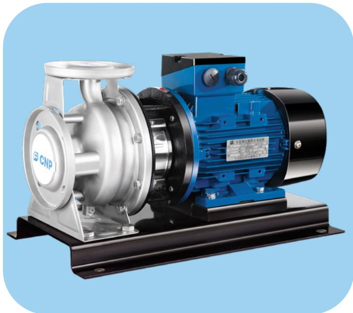
Одноступенчатые моноблочные несамовсасывающие центробежные насосы с горизонтальным расположением вала, осевым всасывающим и радиальным напорным патрубками.
