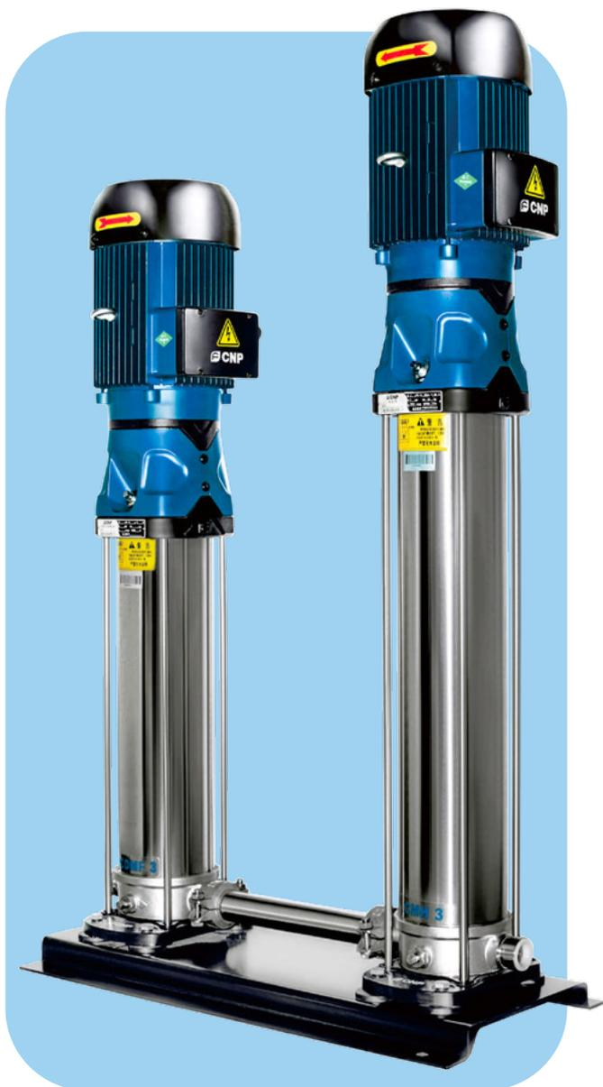
Насосная система CDMF+CMH представляет собой моноблочную конструкцию, состоящую из двух последовательно соединенных насосов CDMF – стандартного питательного насоса – и CMH – специально спроектированного насоса высокого давления. Система сдвоенных насосов CDMF+CMH предназначена для создания высокого давления.
