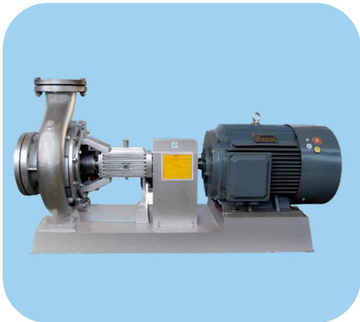
Одноступенчатый консольный насос с осевым всасывающим и радиальным напорным патрубками. Используются для перекачивания слабокоррозионных высокотемпературных жидкостей, которые не содержат твердых частиц.
